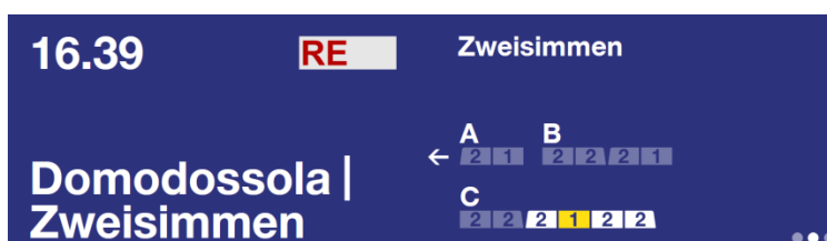
Abbildung 232 Darstellung SBB neue Anzeigergeneration
